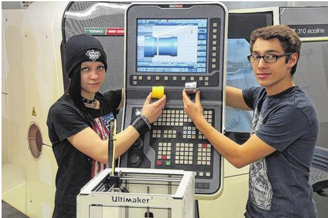
Einmal aus dem 3-D-Drucker, einmal aus der CNC-Drehmaschine: Jennifer Büttner hält den „gedruckten“ Becher aus Plastik, Yassin Bel Mahdi den „Zwillingsbruder“ aus Metall, der in der CNC-Drehmaschine (im Hintergrund) hergestellt wurde. Foto: FOS/Klör
